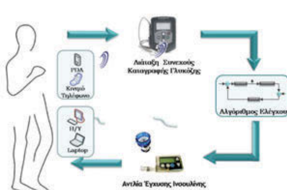
Σχήμα 2: Σχηματικό διάγραμμα «τεχνητού παγκρέατος»
